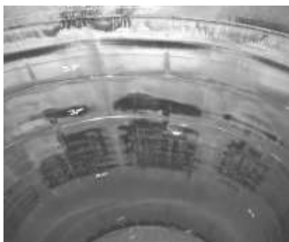
Рис. 4. Натирки на поверхности зеркала втулки (слева) и закоксовывание канавок (справа)
