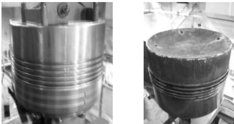
Рис. 5. Состояние головки поршня: до установки на двигатель (слева) и после вскрытия (справа)
