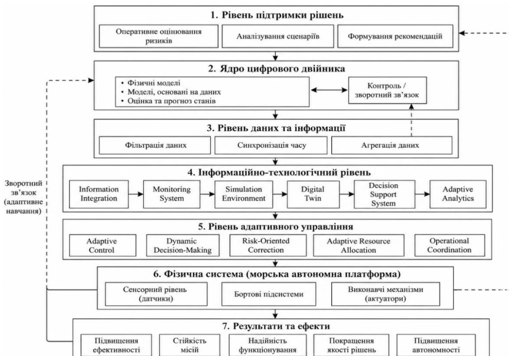
Рисунок 17 – Архітектура інтегрованої системи цифрового двійника морської автономної платформи в умовах невизначеності
